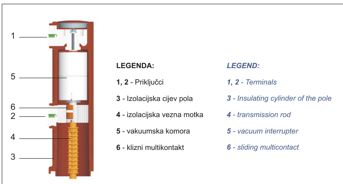
Slika 2 - presjek pola
